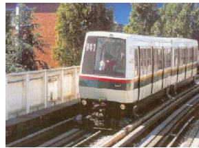
VAL 206 (Véhicule Automatique Léger) in Lille in 1983 with DC motors
